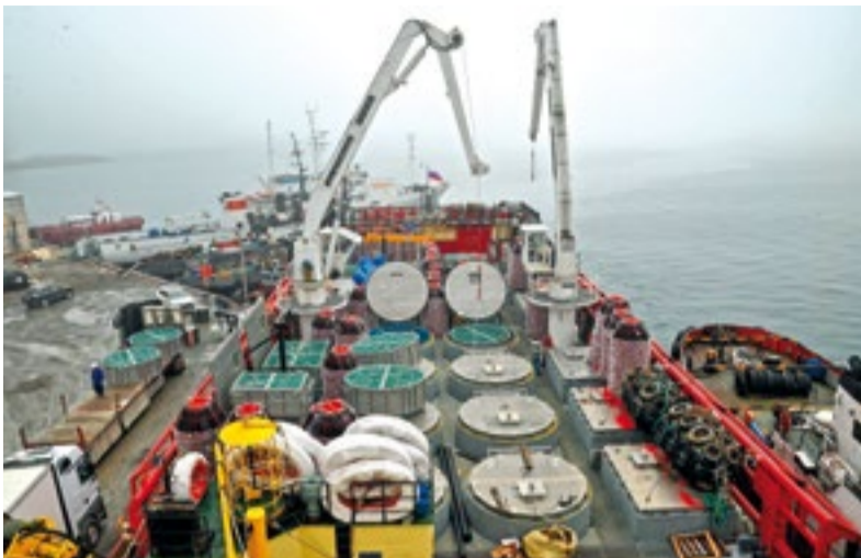
Особенность этого судна — целых 26 крабовых RSW-танков
