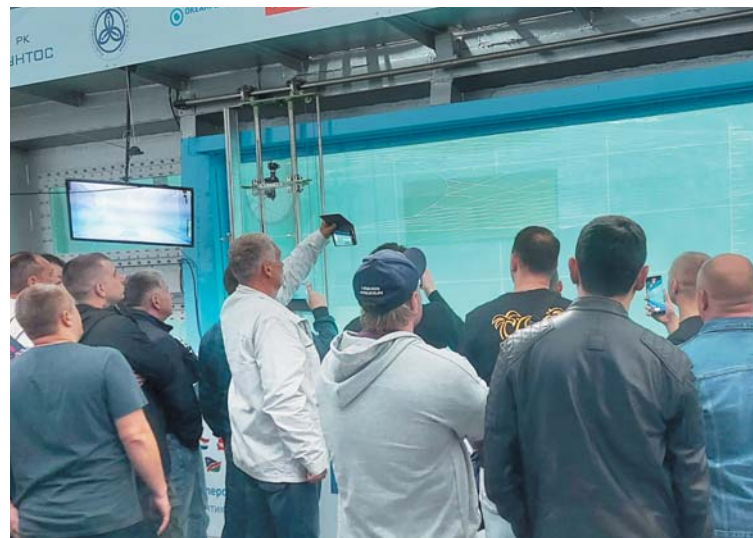
Гидролоток дает возможность рыбакам увидеть, как ведет себя трал под водой, причем гораздо нагляднее, чем на компьютерных моделях или на экране эхолота
