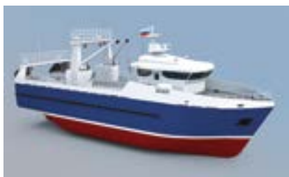
Конструкторским бюро завода «Вымпел» разработаны проекты малых рыболовных траулеров для прибрежного рыболовства. Проект МРТП-30
