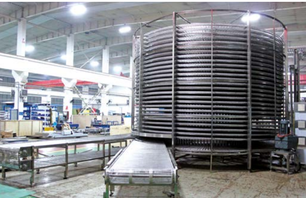
Сборка спиральных морозильных аппаратов в цеху завода Moon Tech
