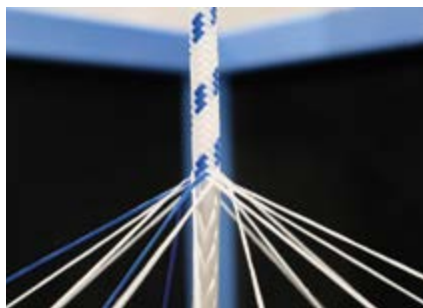
Канат ПЭН – собственная разработка компании. Каждый второй трал «Атлантика» выполнен с применением такого типа канатов
