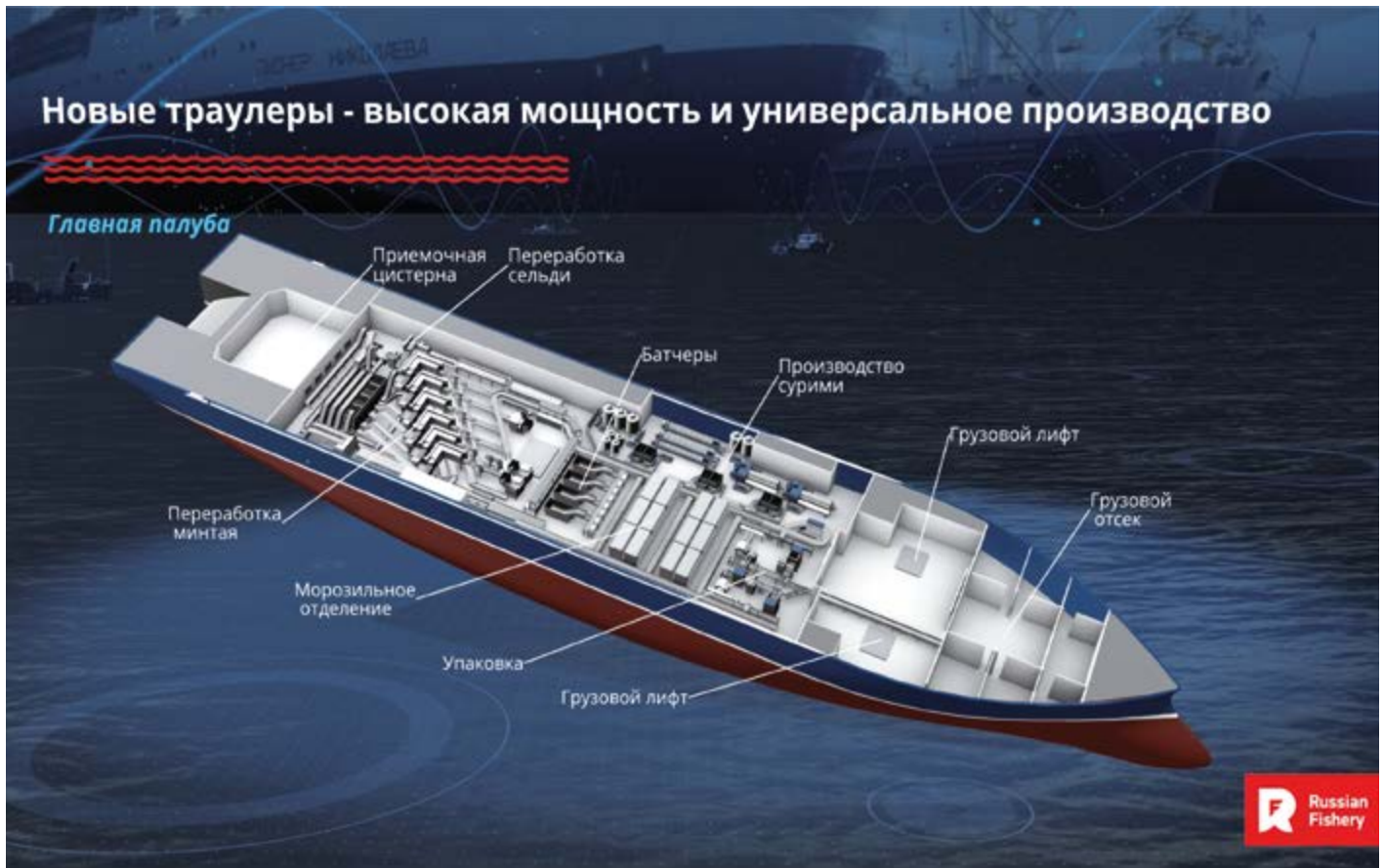
Оснащение современным технологическим оборудованием от лучших мировых брендов позволит производить на борту нового супертраулера все виды продукции из минтая и сельди, включая сурими
