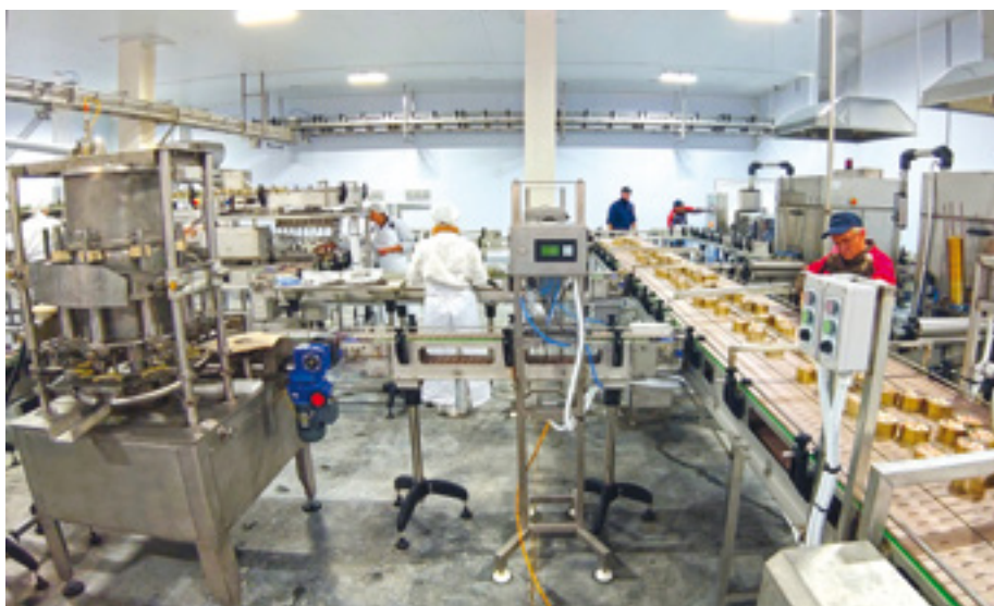
Консервный цех оснащен закаточными и рыбонабивочными машинами калининградского конструкторского бюро им. Л. Г. Кошкина и автоклавом французской фирмы Steriflow. Предполагаемый объем выпуска – порядка 100 туб в сутки
