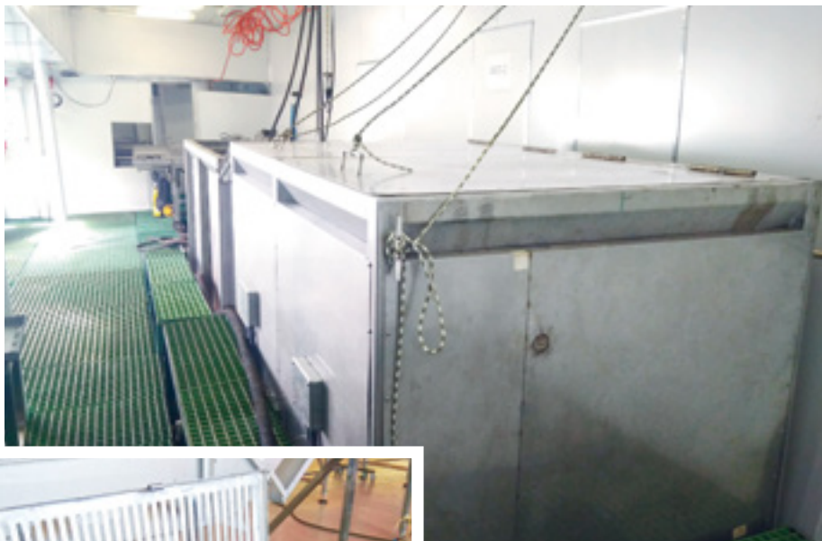
Котел с автоматизированным контролем и управлением режимами варки краба
