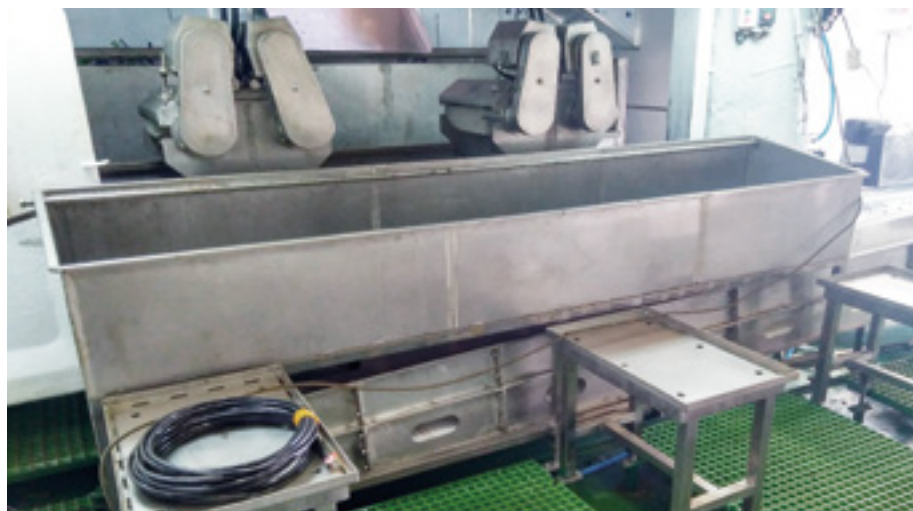
Оборудование для механической подачи краба обработчикам, зачистки конечностей и укладки в технологическую тару (подъемный бункер, «гондурас», модуль укладки)
