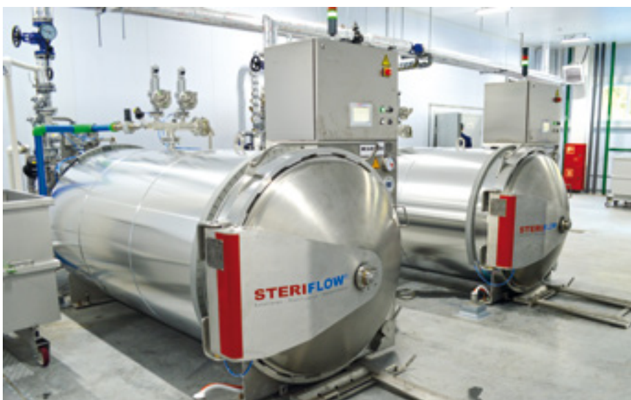
Консервный цех оснащен закаточными и рыбонабивочными машинами калининградского конструкторского бюро им. Л. Г. Кошкина и автоклавом французской фирмы Steriflow. Предполагаемый объем выпуска – порядка 100 туб в сутки
