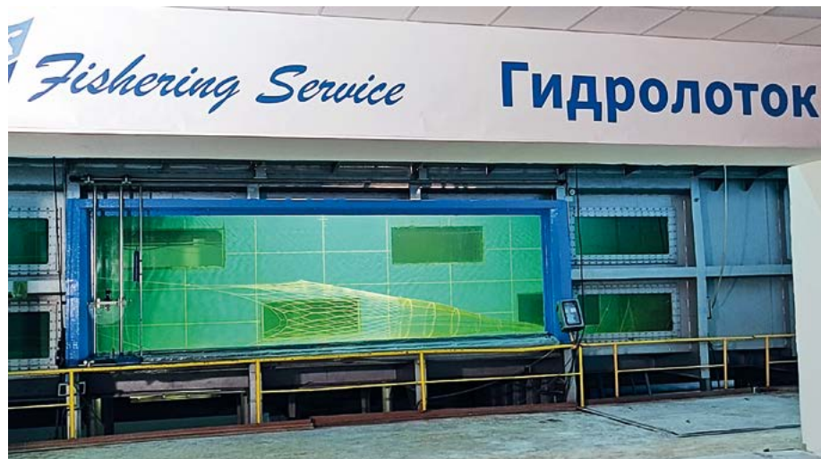
Демонстрация моделей тралов в гидролотке, восстановленном компанией «Фишеринг Сервис»
