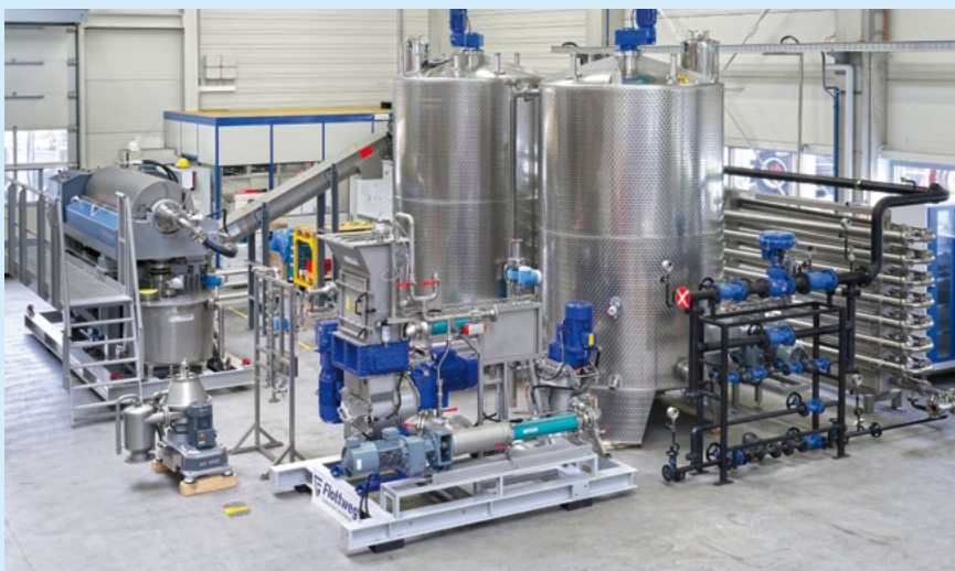
Модульная система Flottweg для переработки 120 тонн красной рыбы в сутки
