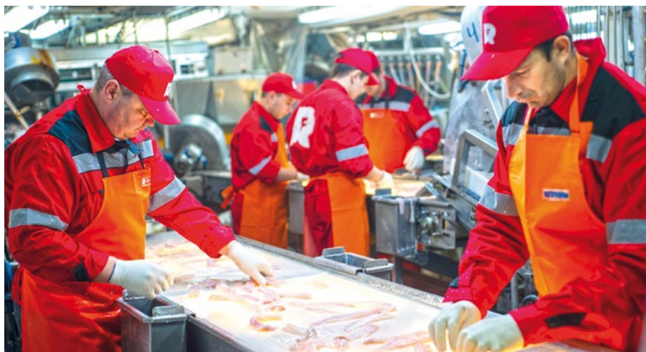
Дополнительный контроль качества выпуска филе минтая проходит на просвечивающей ленте конвейера
