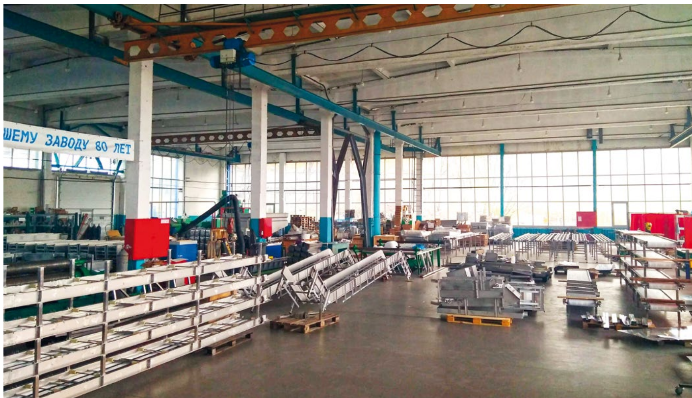
Сборка конвейеров в цехах «Дальрыбтехцентра»
