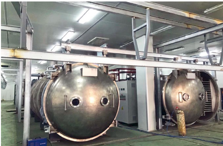
Емкости для вакуумной сушки продуктов, завод Shandong Date Biotechnology Co., Ltd
