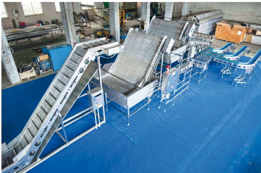
Линия для сортировки креветки – изготовлена Moon Tech с использованием материалов и технологических узлов, которые не нуждаются в обслуживании
