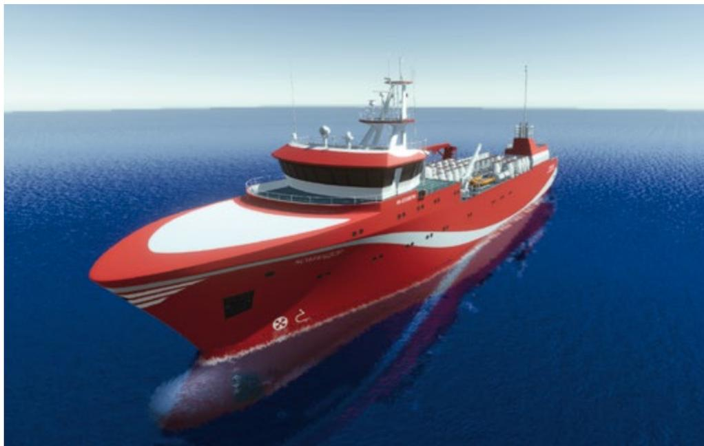
Судно спроектировано под неограниченный район плавания, имеет класс Российского морского регистра судоходства **KM0Ice2 (hull; machinery) Aut2 (REF) Fishing Vessel**.
