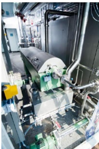
*Модульная установка GEA позволяет получать высококачественный рыбий жир даже при низких температурах*
