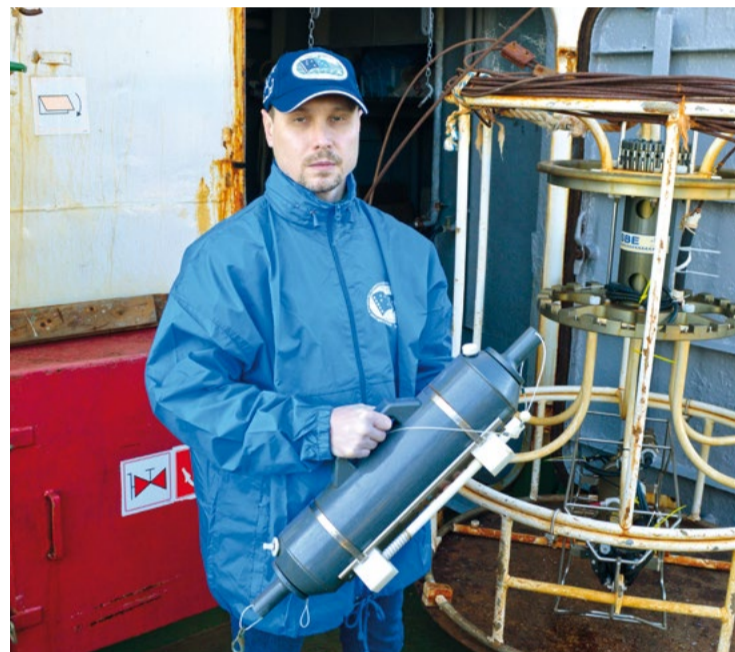
Батометр для отбора проб воды на заданной глубине и гидрологический зонд
