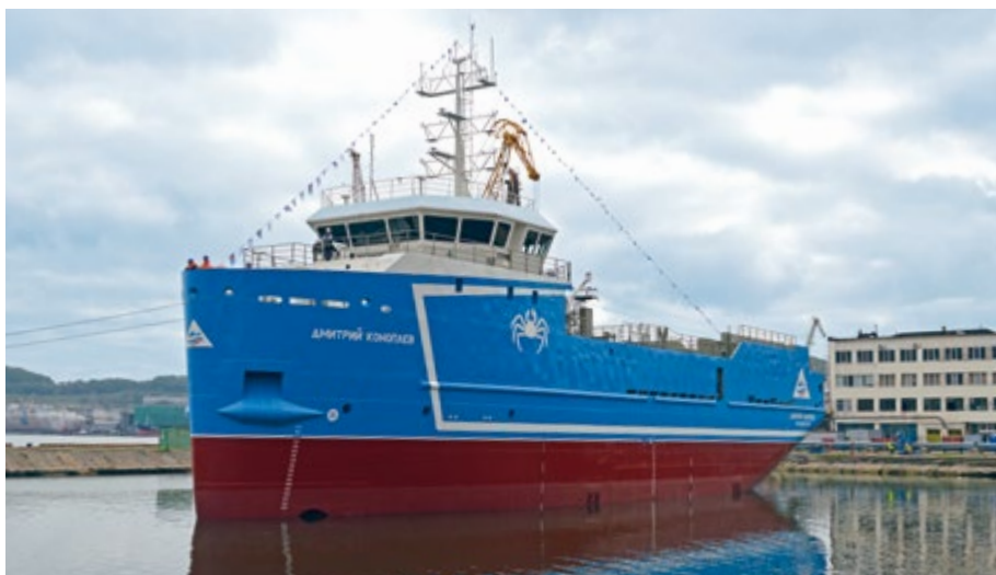
Характеристики новых судов: длина — 57,7 м, ширина — 12,6 м, дедвейт — около 1200 тонн, осадка — 5 м, скорость — 12,6 узла, экипаж — 24 человека
