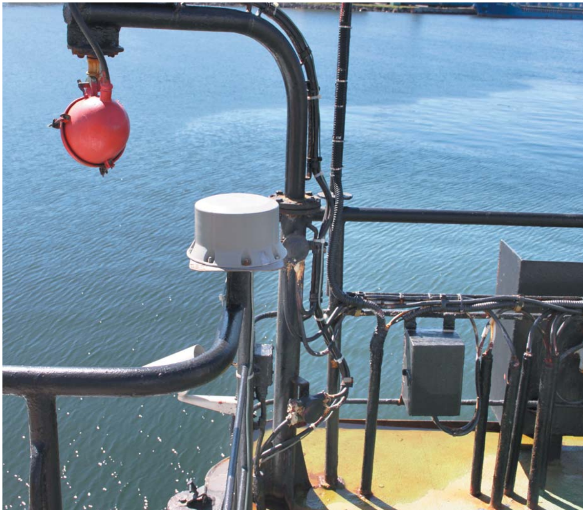
Антенна судовой станции «Гонец» на рыбопромысловом судне
