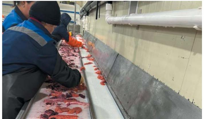
После разделки икра и внутренности идут отдельно по конвейеру дальше на разбор
