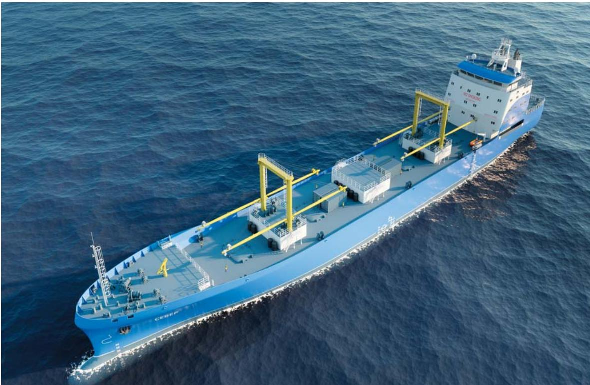
3D-модель приемно-транспортного рефрижератора проекта V145RFT «Север»
