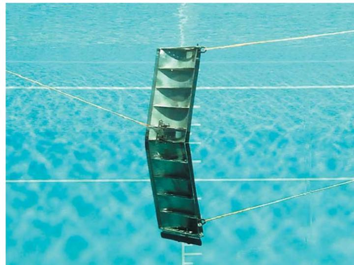
Испытание новой модели траловой доски разработки «Фишеринг Сервис»
