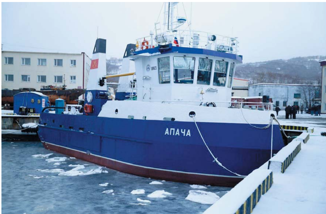
МРС «Апача» создан рыболовецким колхозом имени В.И. Ленина по программе инвестиционных квот. Это первый из шести судов типа «Нельма» с притоняемым донным неводом — снюрреводом
