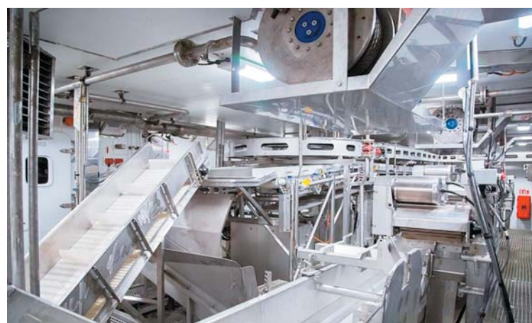
«Кильдин» оснащен линией переработки и упаковки готовой продукции суточной производительностью до 40 тонн варено-мороженого краба
