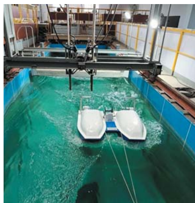
Катамаран для испытаний автоматизированной системы траления
