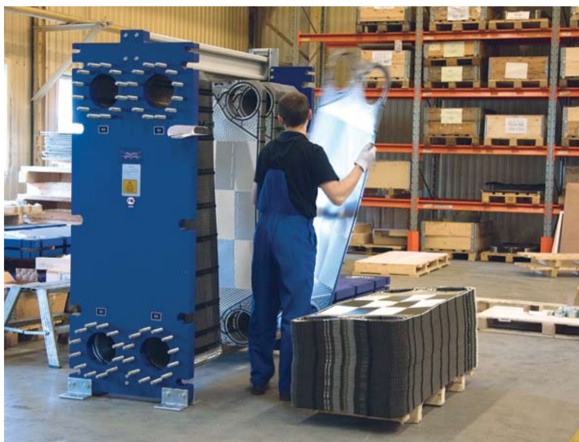
Сборка пластинчатого теплообменника «Альфа Лаваль»
