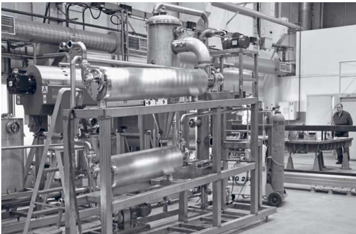
Установка «Альфа Лаваль» по переработке рыбных отходов
