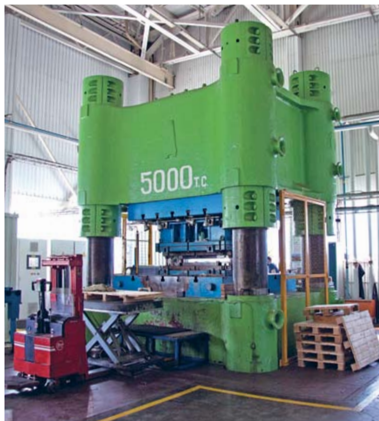
Уникальный пресс для производства пластин на заводе «Альфа Лаваль»
