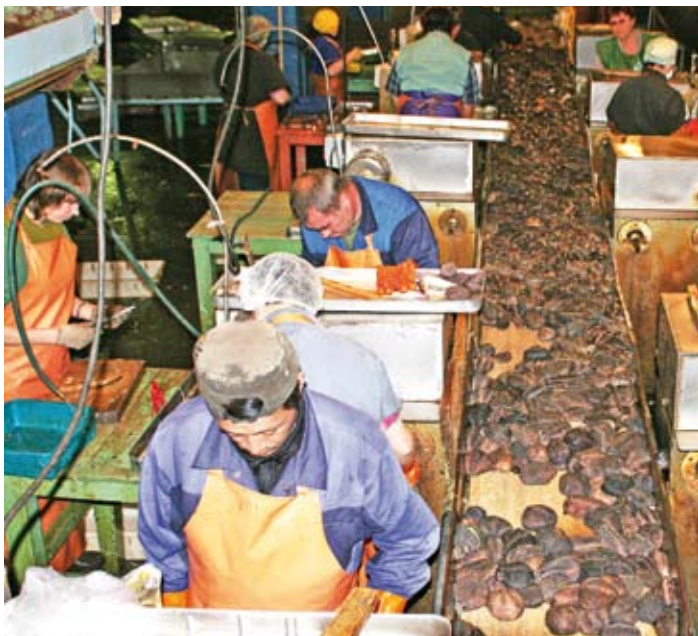
Оборудование разделочной линии кукумарии изобрели и смонтировали специалисты колхоза
