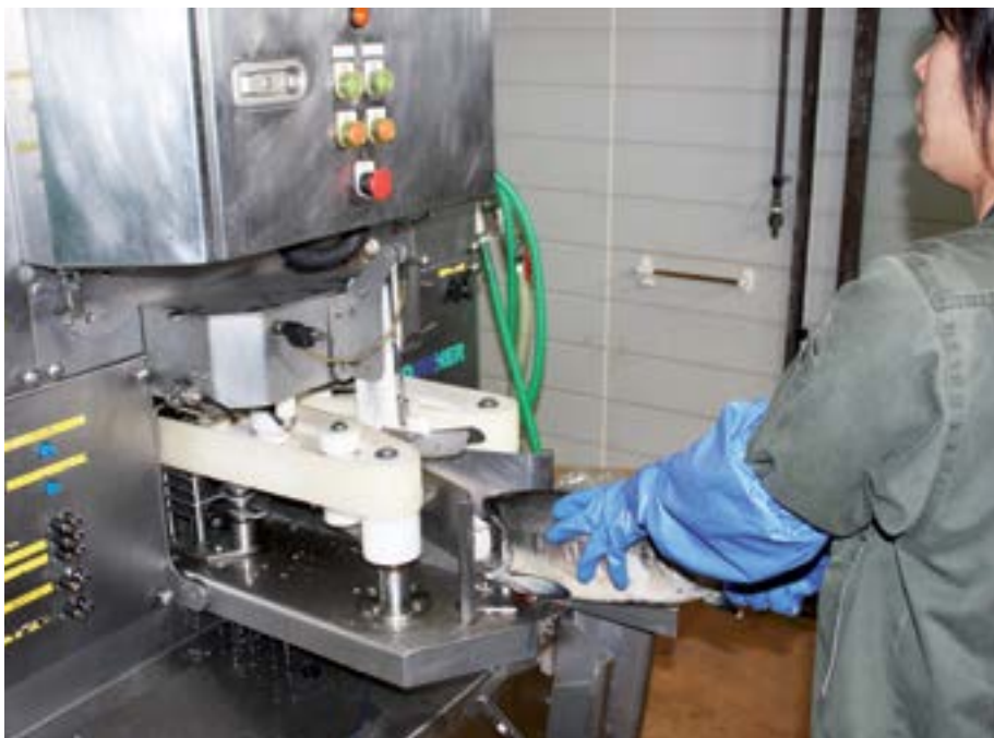
Глубокая переработка по-японски: разделка сырца на филе при помощи универсальной филетировочной машины NSB-300
